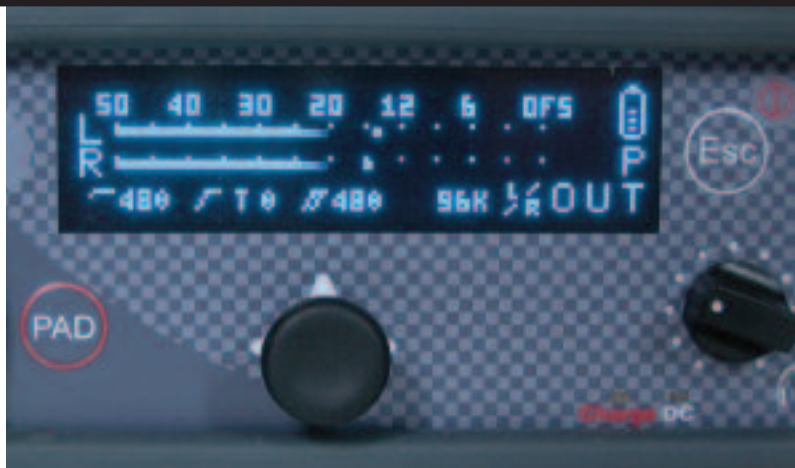
Mit einem Blick alles im Blick. Im Multimodus erscheinen zusätzliche drei Balkenanzeigen für die Eingangskanäle im Display.
